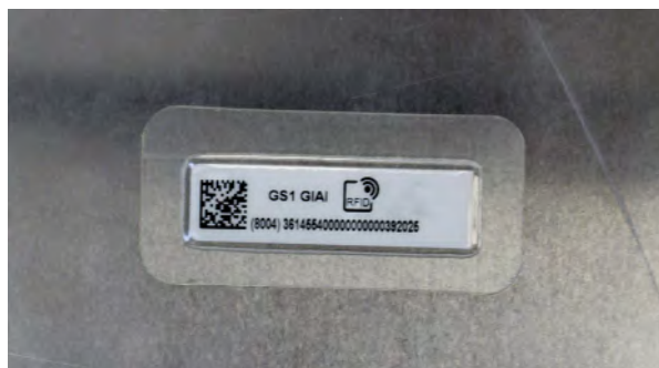
Identification de pièces extérieures en métal
