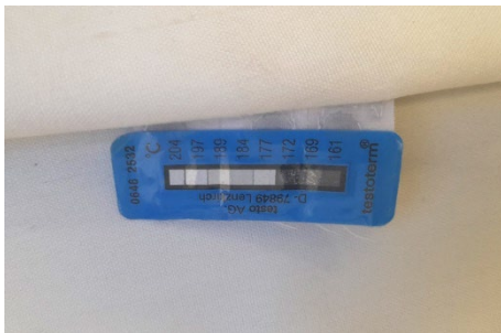
La température de la colle est de 172 degrés. La procédure est validée.
