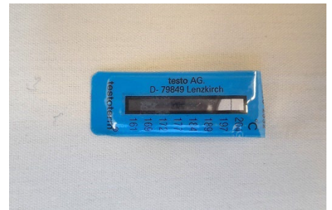
La température est trop haute. La procédure doit être recommencée avec une température inférieure.
